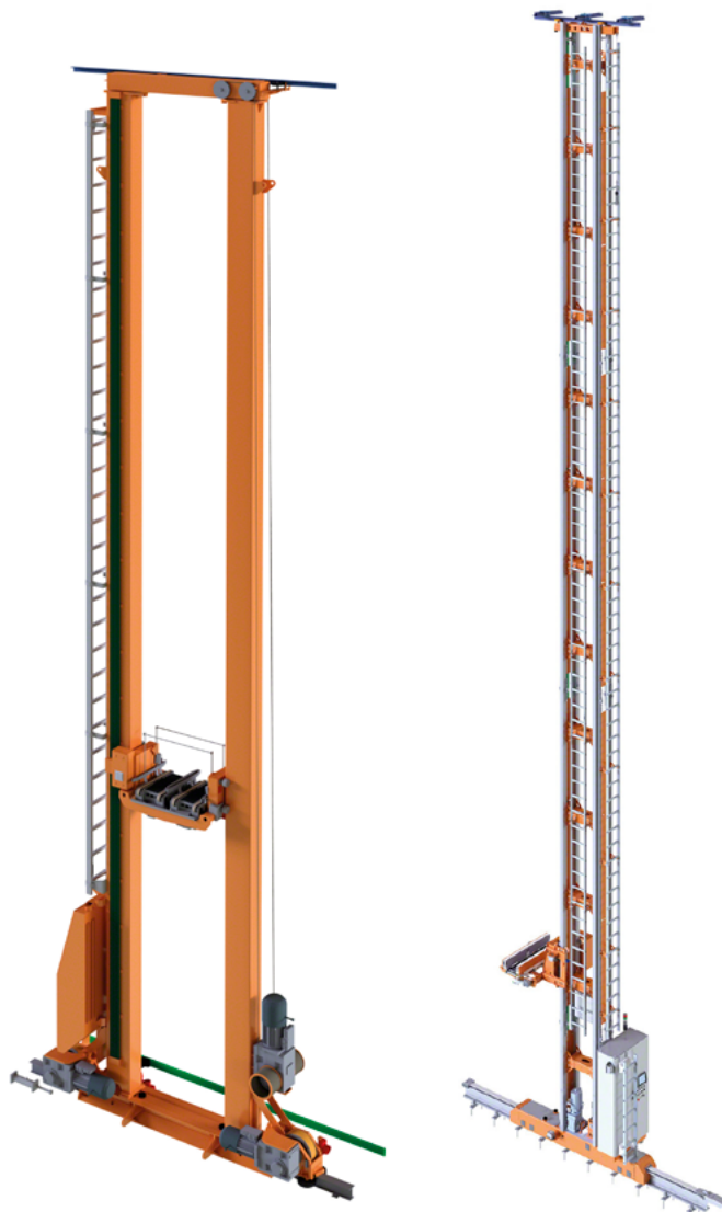
MLB100Q dvigalo z dvojnim nosilcem Lahko doseže do 20 m višine in prenese dve 100 kg tovorni enoti ali štiri 50 kg tovrne enote.
