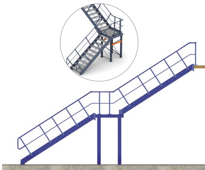
Stopnice z medetažo (neprekinjene stopnice s podestom)
