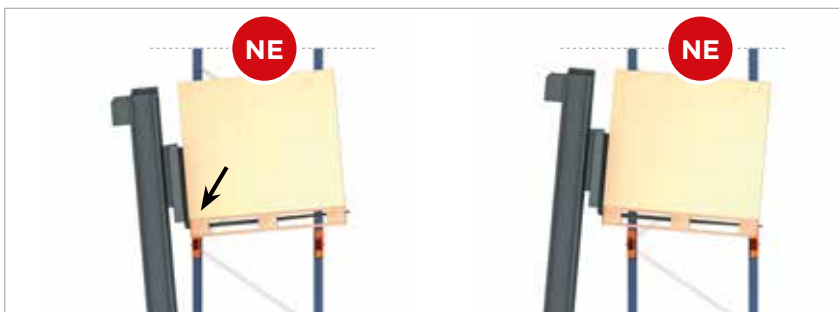
Slika 9. Preobremenitev nosilca, ker paleta ni bila spuščena vodoravno.
